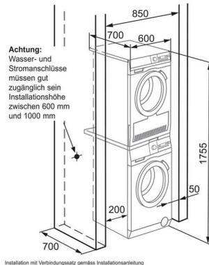
Belüftungsbeispiel für Wasch-Trockensäule, Schrankinbau, Tür muss bei Betrieb geöffnet sein (Belüftung in Möbel integriert)
